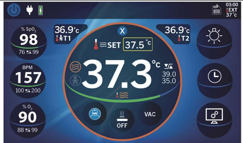
Verwenden Sie das Rad, um den Solltemperaturwert zu wählen. Der Wert wird orange hervorgehoben und kann jetzt vom Bediener mit dem Rad geändert werden.
