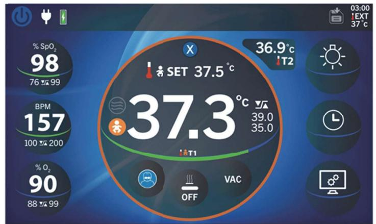
Sobald der Modus ausgewählt ist, wird eine „Set Temperature“-Warnung des Meldungscenters angezeigt. Der Solltemperaturwert ist jetzt orange hervorgehoben und der Wert kann geändert werden. Sobald der gewünschte Solltemperaturwert angezeigt wird, wählen Sie den Wert mit dem Rad aus, um die eingestellte Temperatur zu bestätigen und zu speichern. Jetzt arbeitet das System im Servosteuermodus.
