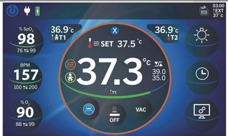
Das Servomodus-Symbol wird orange hervorgehoben, um die Auswahl zu bestätigen, und der T1-Temperaturwert bewegt sich von außerhalb des Kreises auf den aktiven Temperaturwert innerhalb des Kreises. Das Symbol unter dem aktiven Temperaturwert und das Symbol neben dem eingestellten Temperaturwert ändert sich in den T1- und Servosteuermodus. Das Luftregelungssymbol ist jetzt inaktiv und ausgegraut. Temperaturalarmgrenzwerte sind standardmäßig auf Servosteuermoduswerte festgelegt.
