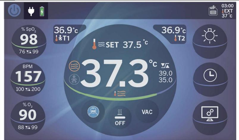
Die Batterieladung in Prozent wird 3 Sekunden lang über der Ausschalttaste angezeigt.
