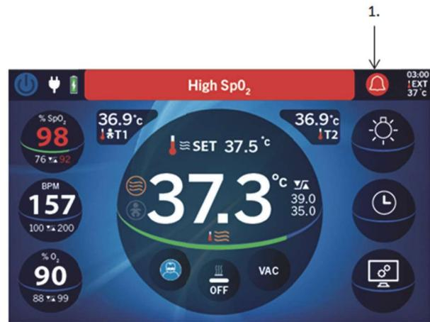
Das Audio-Pause-Symbol wird rechts neben der Alarmmeldung angezeigt, um anzuzeigen, dass der Alarmton angehalten wurde. Der Alarmton beendet die Wiedergabe des aktuellen Alarmtons und wird dann angehalten. Berühren Sie die Alarmleiste, um den Alarmton zu beenden. Wenn ein weiterer Alarm auftritt, während der Ton des aktiven Alarms angehalten ist, wird der Alarmton nicht angehalten. Die Dauer der Alarmton-Pause ist spezifisch für den Alarm und wird in der Alarmtabelle definiert.
